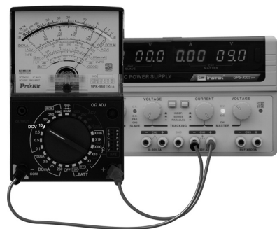
↑ 圖 3-2.10 直流電壓測量(-)
