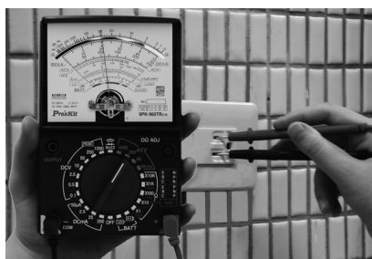
↑ 圖 3-2.11 交流電壓的測量
